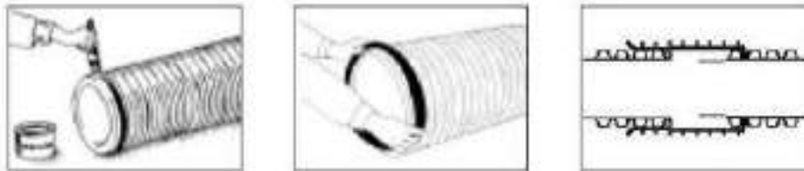
Fig. Lidhja e tubave të korruguar me qafëz në formë gote
