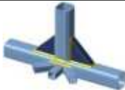
Fig.3.2.3.2. Saldimi i dy e më shumë materialeve
